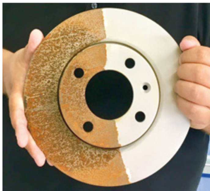
Abb. 9 // Halb beschichtete Bremsscheibe mit silberner Nano-Emaille nach 16 h Salzsprühnebeltest.
