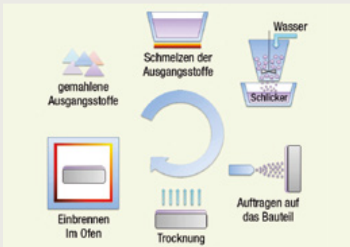
Abb. 2 // Schema des Emailierprozesses (Abbildung: Dipl.-ing-metaller, Wikipedia).
